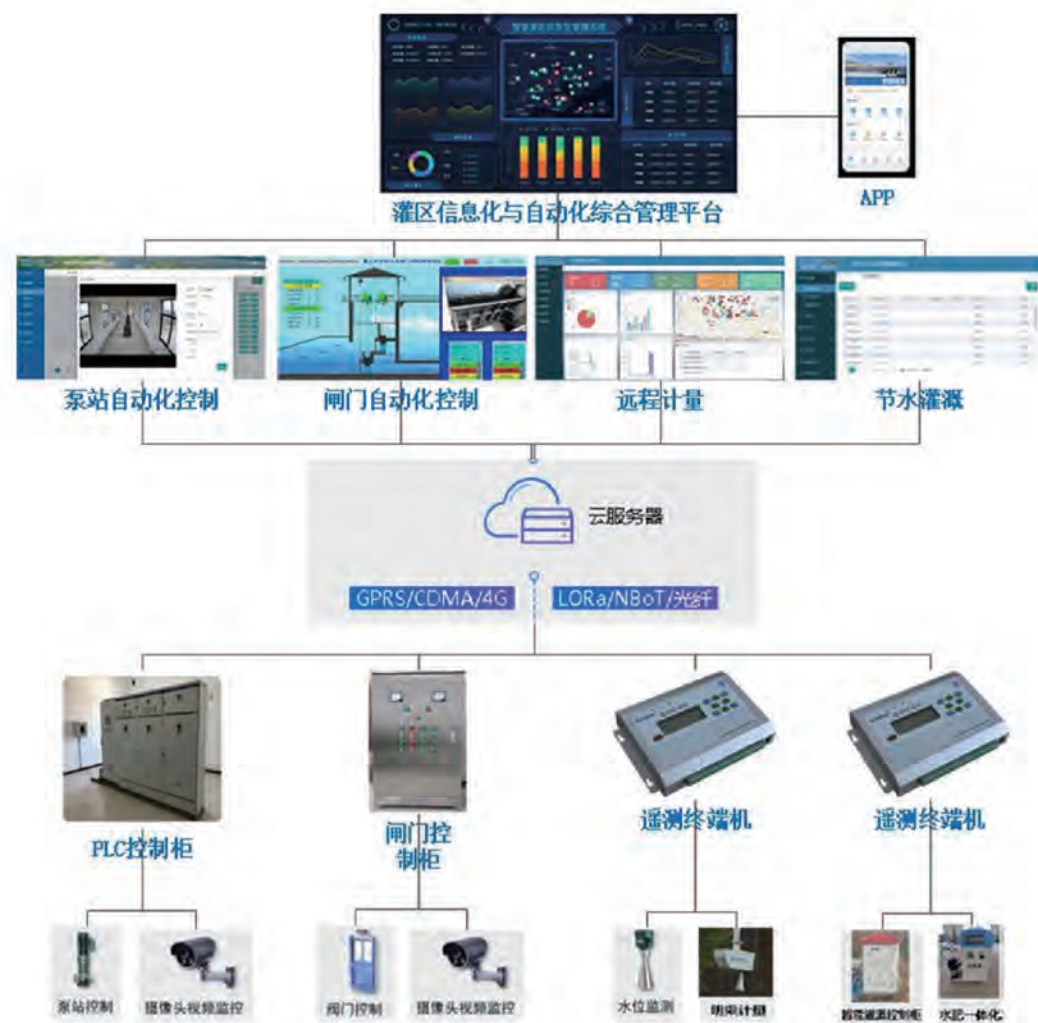
遥测终端机在灌区项目中的应用
